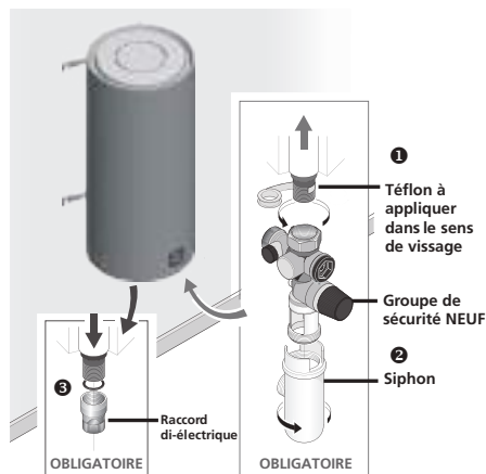
Branchement eau chaude
